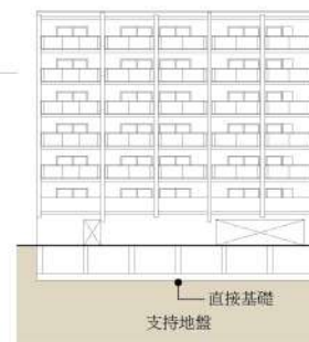
参考図: 直接基礎工法
